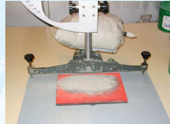
Dispositif de mesure sur réplique de chaussée, fines de NaCl Dosage 2
