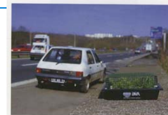
Photo 1 ■ Aspect du kit de détection constitué d'un bac-réservoir d'eau (20 x 30 cm) sur lequel flottent les 2 boîtes de cultures insérées dans un bloc de polystyrène. Un ombrage protège les plantules de tabac.
