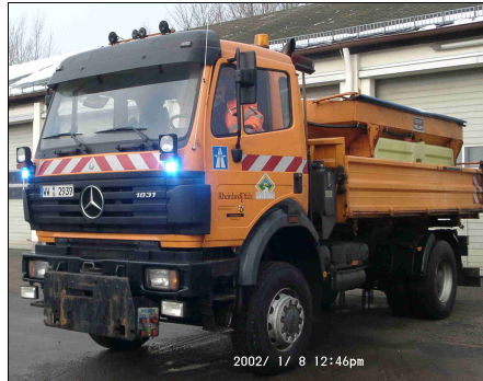
Figure 6 : Véhicule de service d'hiver muni de feux flash et d'avertisseurs à plusieurs tons
