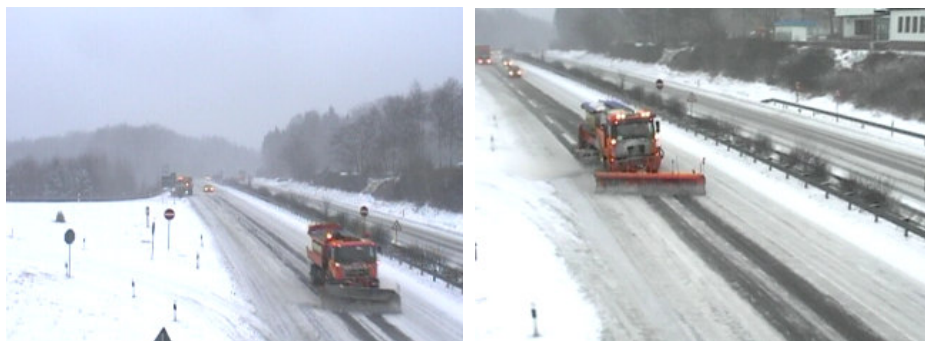
Figure 4 : Comparaison des résultats de dégagement par véhicule de service d'hiver standard (à gauche) avec ceux par souffleuse-balayeuse à haute performance (à droite)
