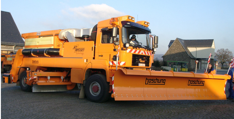
Figure 3 : Souffleuse balayeuse à haute performance comme véhicule de service d'hiver routier
