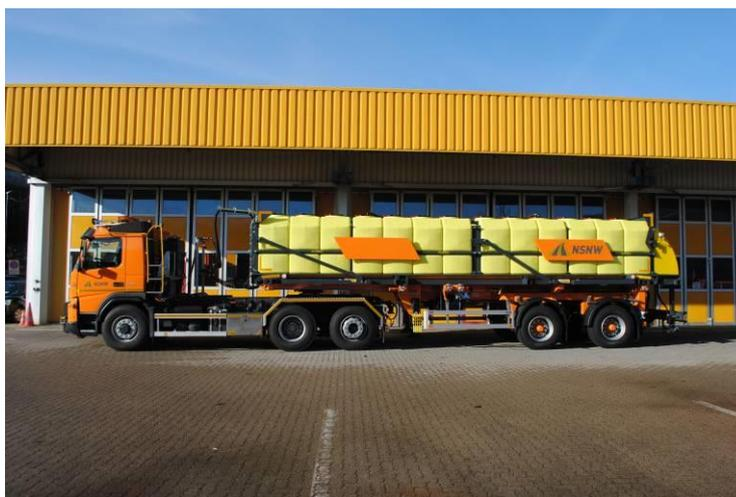
*Illustration 8 : Grand épandeur de saumure d'une capacité de 20 000 litres utilisé en Suisse*
