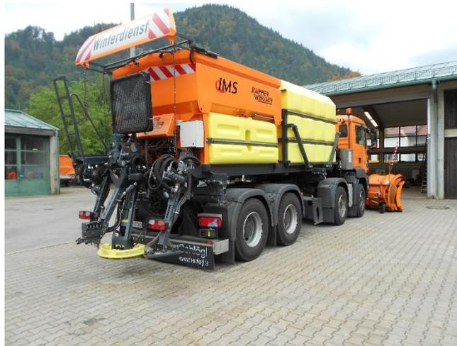
*Illustration 20 : Épandeur combiné à 4 essieux (avec buses et disques) et à capacité maximale en Allemagne*
