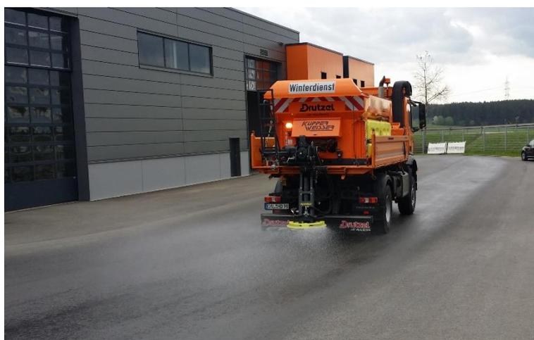
*Illustration 23 : Épandage de saumure uniquement (FS 100) avec disque d'épandage en Allemagne*
