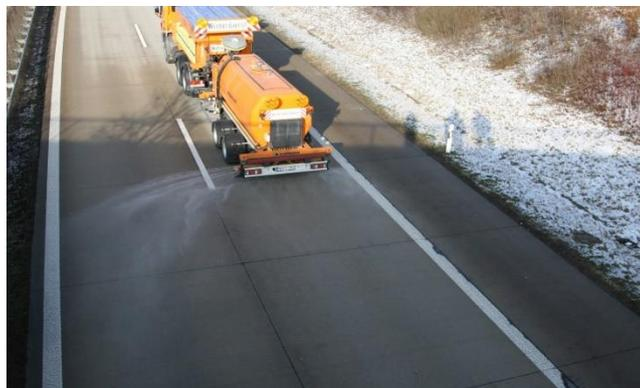
*Illustration 21 : Un camion avec épandeur de pré-humidification qui remorque une citerne pour l'épandage de saumure en Allemagne*
