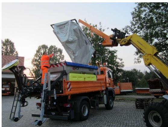
*Illustration 22 : Épandeur combiné flexible avec un sac de saumure dans la trémie en Allemagne*
