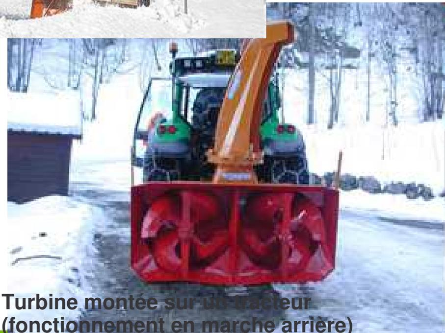
Turbine montée sur un tracteur
