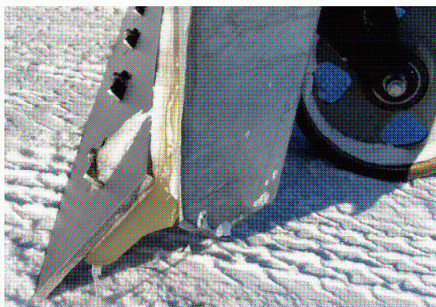
Les porte-lames d'usure flexibles et la lame de déneigement écologique sur le camion
