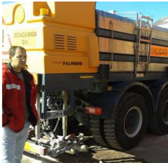
*Centre d'exploitation de Puente del Inca, le principe c'est bien sûr d'évacuer la neige mais de plus en plus on s'intéresse au précuratif neige (pour éviter le collage) avec une épandeuse à saumure (dont le constructeur est italien.)*
