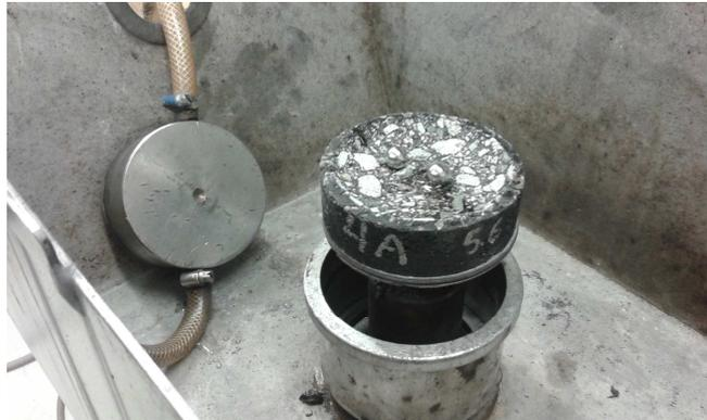
*Un laboratoire où l'on simule le comportement au gel des sols et structures, ainsi qu'une machine pour comprendre l'effet des pneus cloutés en terme d'usure des couches de surface et de production de particules fines.*
